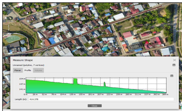
รูปที่ 17 แสดงรูปตัดตามขวาง (Cross section) ตามแนวถนนบริเวณเทศบาลตำบลตาลเดี่ยว อ.หล่มสัก จ.เพชรบูรณ์
