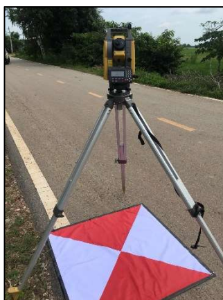
รูปที่ 4 เป้า GCP ขนาด 1 x 1 เมตร
