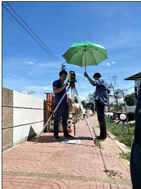
รูปที่ 7 แสดงการสำรวจตำแหน่งพิกัดจุดควบคุม โดยวางรอบด้วยกล้อง Total Station
