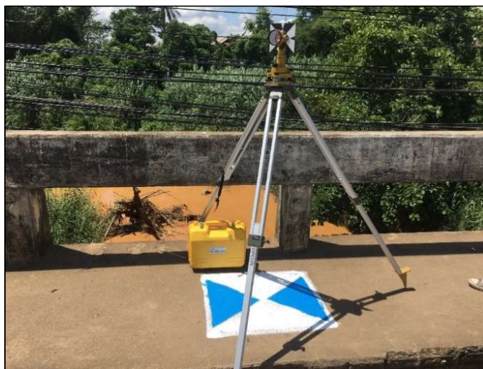
รูปที่ 6 แสดงการสำรวจตำแหน่งพิกัดจุดควบคุม โดยวางรอบด้วยกล้อง Total Station
