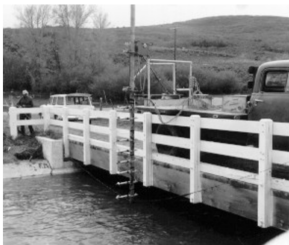
ตัวอย่างการตรวจวัดจากสะพานที่ติดตั้ง Propeller current meter 8 ตัว
