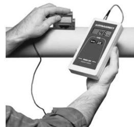
รูปที่ 13-12 ลักษณะการทำงานของ Ultrasonic Doppler flow meters
