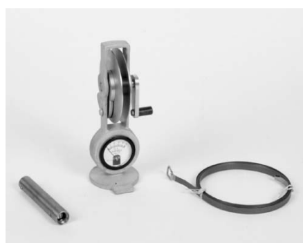
ตัวอย่างเครื่องวัดที่สายวัดเป็นเทปวัดระยะที่มีสายสัญญาณฝังในตัว
