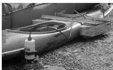
รูปการติดตั้งเครื่องวัดกับเรือพาย
