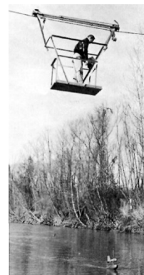
รูปที่ 6-24 แสดงกระเช้าแบบหนึ่ง และการตรวจวัดจากรถกระเช้า
