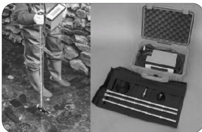
รูปที่ 7-7 แสดงการตรวจวัดที่ใช้หัววัดที่ติดตั้งกับ Wading rod
